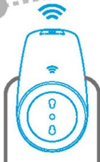
Inserire il NEO in una presa di corrente, quindi premere e mantenere premuto il tasto ON/OFF per 5 secondi. Rilasciarlo quando la spia luminosa Wi-Fi lampeggia velocemente. L'interruttore NEO è ora pronto per la sincronizzazione.
